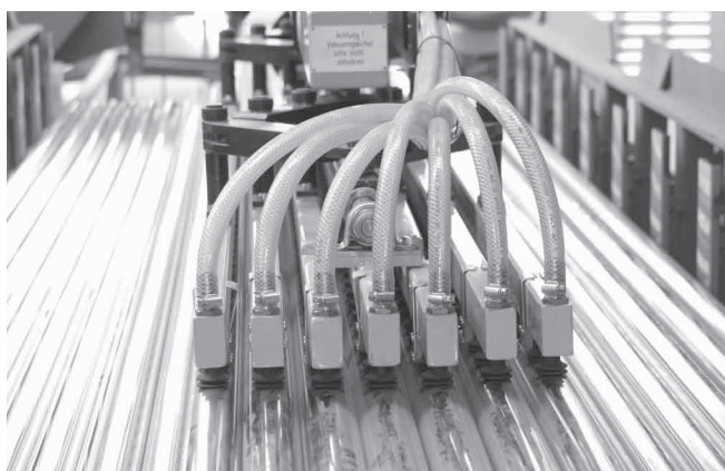
Манипулирование трубами с помощью адаптируемых вакуумных присосок FSG
